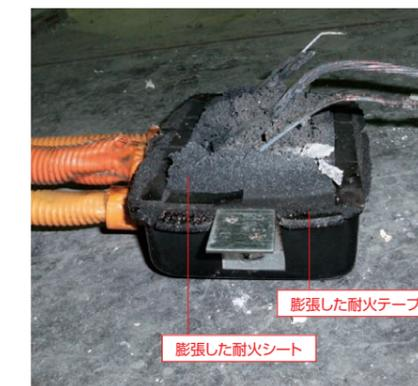
耐火シートが膨張しボックス内を完全に埋めます。
