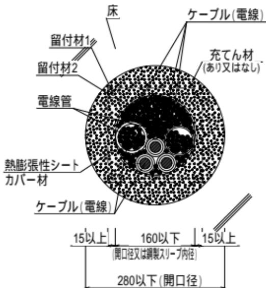
注) ケーブル・電線管の配置の一例を示す
