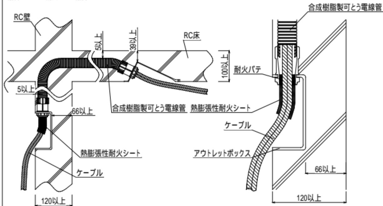
構造:RC壁120mm以上、RC床100mm以上
