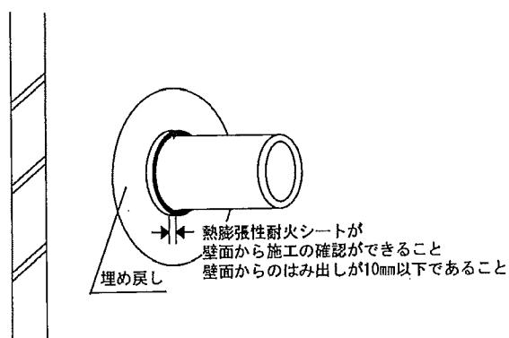
(2) 水道配水用ポリエチレン管及び給水用高密度ポリエチレン管の標準施工図
