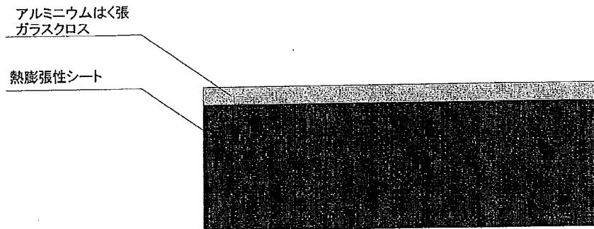
図-1 热膨張性耐火シートの構造
